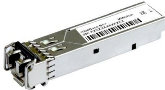
Гигабитный SFP-трансивер OM-312 для многомодового оптического кабеля разработан для установки в порт SFP (Small Form-Factor Pluggable) сетевого устройства с целью приема и передачи данных по оптоволоконным кабелям. Данный трансивер выполнен в компактном корпусе и обеспечивает высокоскоростную и надежную передачу данных, используя длину волны 1310 нм, на расстояния до 2км, а также простоту в установке
